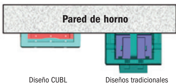
Figura 9 Diseños de quemador
